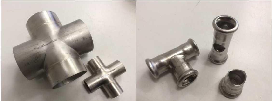
Kuva 18. Yhden akselin liikeradalla (vasemmalla, kaulus) ja kahden akselin liikeradalla (oikealla, satula) tehdyt hitsaukset. Oikean puoleisessa kuvassa esitetään myös kahden akselin liikeradalla tehtävään hitsaukseen valmistetut komponentit.
