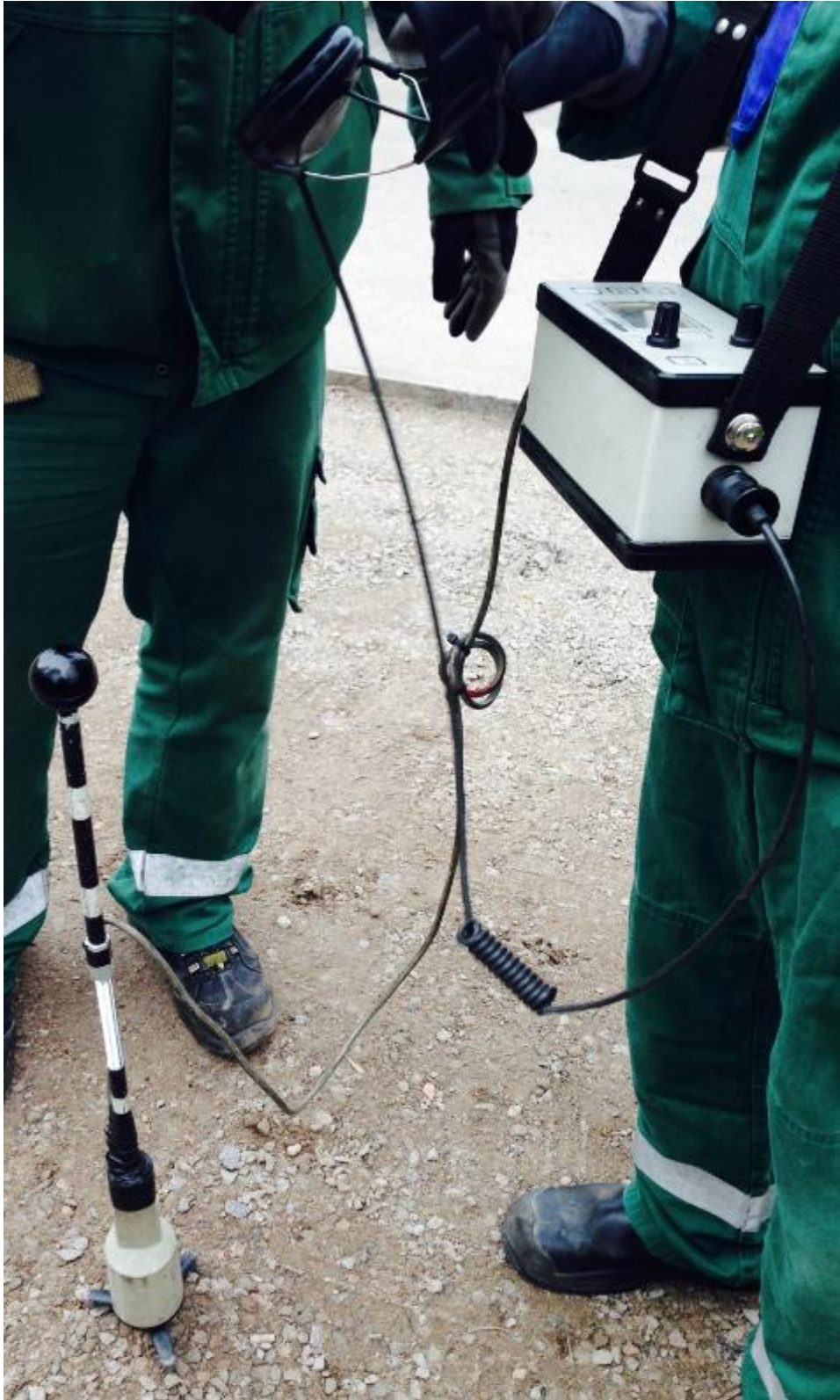
Kuva 12. Maamikrofoni ja siinä kiinni oleva paikannuslaite, sekä kuulokkeet.
