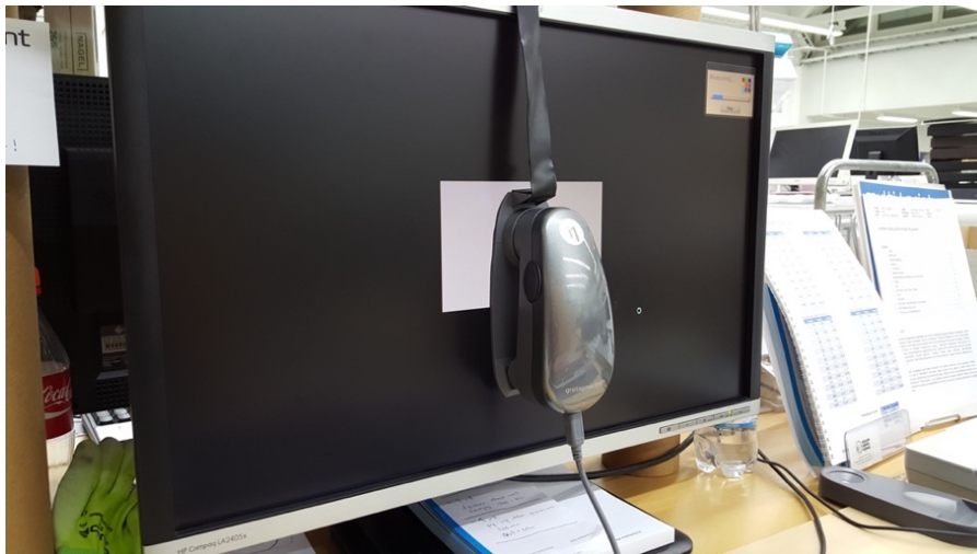
Kuva 6. Spektrofotometri ja näytön kalibrointi (Ojakangas 2015)
