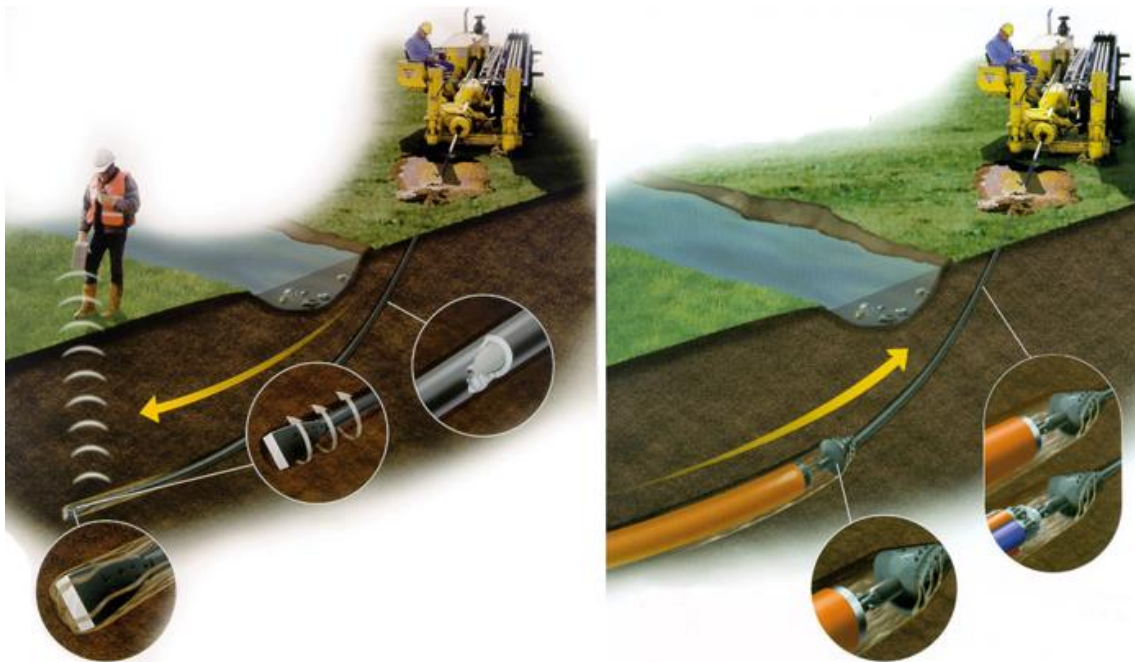
KUVA 15. Piloottiporaus ja putken veto (22)
