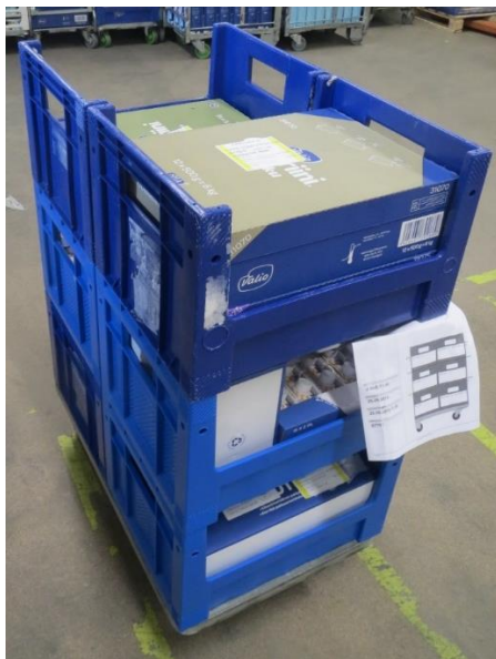
Kuvio 6. Alusvaunu, jonka päälle on koottu PL240- laatikoita eli vaunukko.
