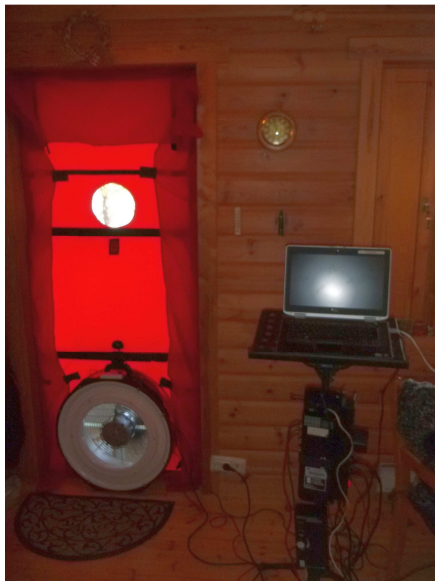
KUVA 10. Minneapolis Blower Door asennettuna oviaukkoon. (Kuva: Jarno Oravasaari 2015)
