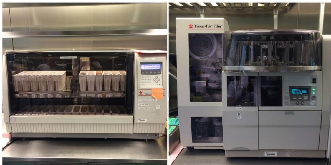
Kuvio 8. vas. Värejäysautomaatti, jolla suoritimme parafiininpoiston laskevalla alkoholisarjalla oik. Tissue-Tek- Film- peittelyautomaatti.
