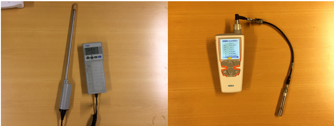
KUVA 4 Suhteellisen kosteuden mittauslaitteistoa
