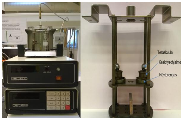
Kuva 13. Rengas-kuula-menetelmässä pehmenemispistemittauksessa käytetty laite ja näyteteline.
