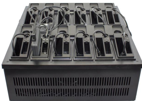
Kuva 16 FirstVu - kamerajärjestelmän virranlataus- ja tallenteen siirtoasema
