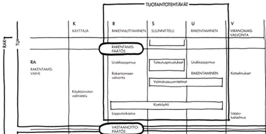
Kuva 5. Rakentamisvaihe talonrakennushankkeessa. (RT-kortti 10-10387 1989, 4.)
