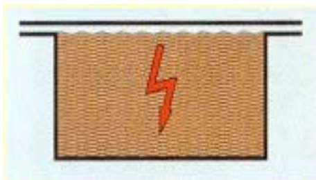
Kuva 8 Öljytäytteinen rakenne (Exo)/9/
