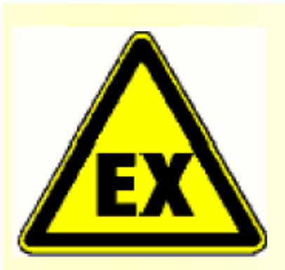
Kuva 2 Olosuhdedirektiivin mukainen EX-tilan varoitusmerkki /16/
