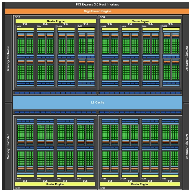
Kuva 16. Maxwell arkkitehtuuri. CUDA-ytimet (vihreä), välimuistit (sininen), PolyMorph engine (keltainen). [15]
