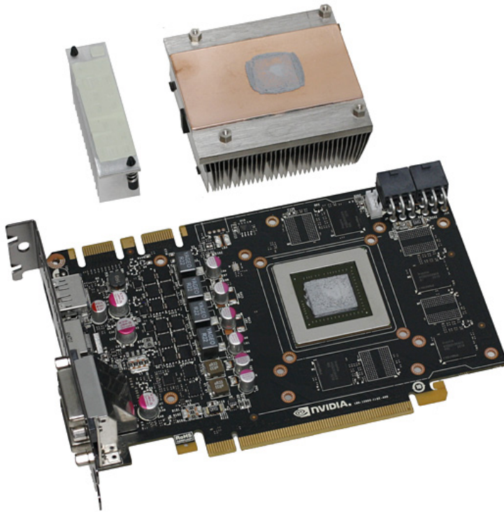
Kuva 2. GTX 670 näytönohjaimen sisältö. [2]
