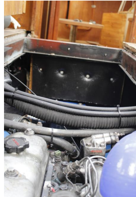
Kuva 5 Äänieristystä konetilan etuseinässä (Kuvannut P. Vallinmäki)
