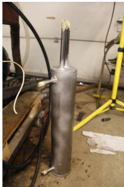
Kuva 2 öljynjäähdytin (Kuvannut P. Vallinmäki)
