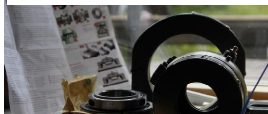
Kuva 11 Coopers halkaistava rullalaakeriyksikkö (Kuvannut P. Vallinmäki)
