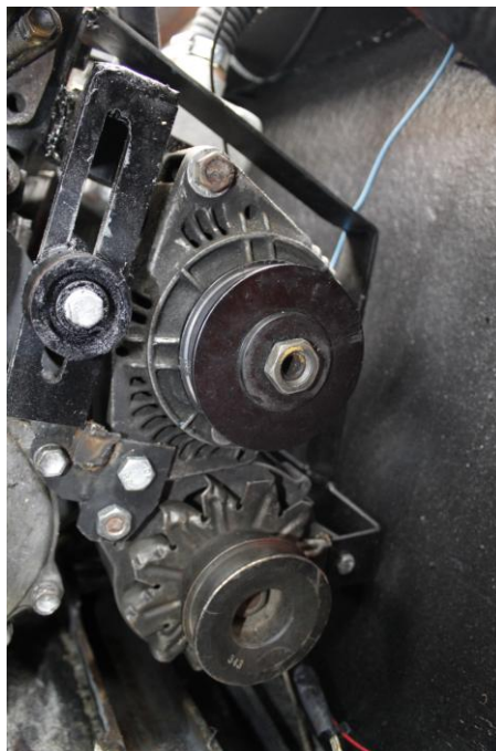
Kuva 12 Laturit omassa telineessään (Kuvannut P. Vallinmäki)
