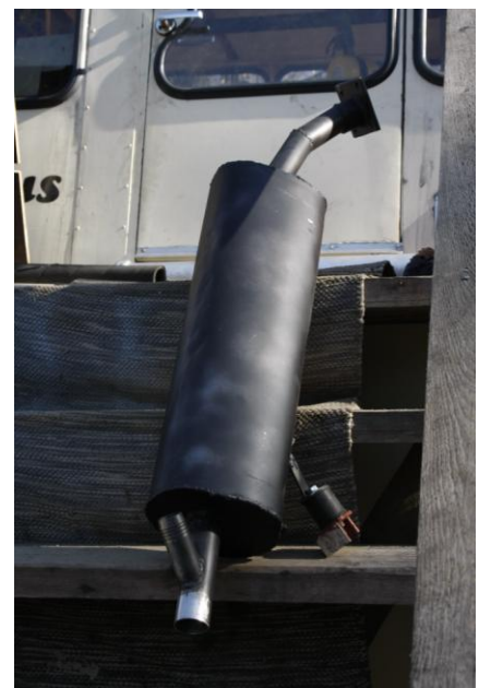
Kuva 6 äänenvaimennin (Kuvannut P. Vallinmäki)
