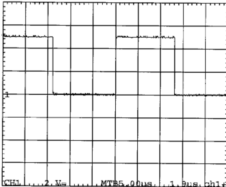
Kuva 3 16F84-piiriin tuottama 38 \text{ kHz} :n taajuus
