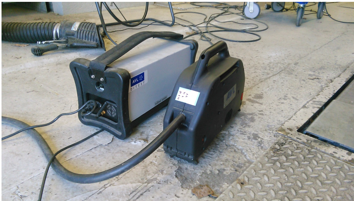
Kuva 1. AVL DISMOKE HEAT 480 -opasiteettimittari edessä ja AVL DITEST SMOKE 2000 -mittalaitte takana.
