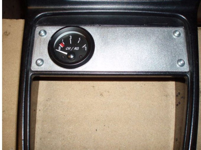
Kuva 33 Valmis asennuslevy etupuolelta
