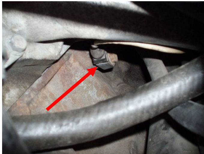
Kuva 24 Nakutusanturi moottorin lohkon kyljessä
