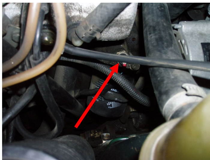
Kuva 27 Öljynpaineanturi öljynsuodattimen yläpuolella
