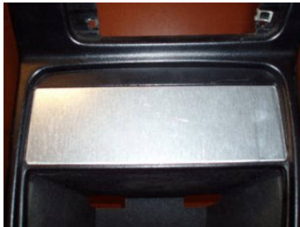
Kuva 32 Öljynpainemittarin asennuslevyn sovitus
