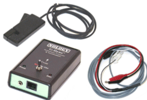
Kuva 9 G-Dyno ja kierrosluvun mittaukseen käytettävät johdot /14/
