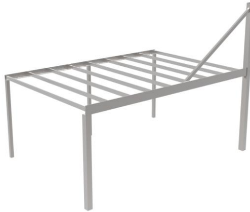
Kuva 7. Luonnosteltu malli 2. Vinotuki etummaiselle tukipalkille olisi mahdollistunut tukipalkin matalamman profiilin valitsemisen, koska sen jänneväli olisi puolittunut. Tämä olisi kuitenkin kohdistanut suuren voiman vinotuen liitokseen.
