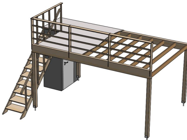
Kuva 4. Puusta valmistettu parvirakenne kaiteella. Tukipilarit tuettu pilarikenkiin, jotka valettu betoniin rakennusvaiheessa.
