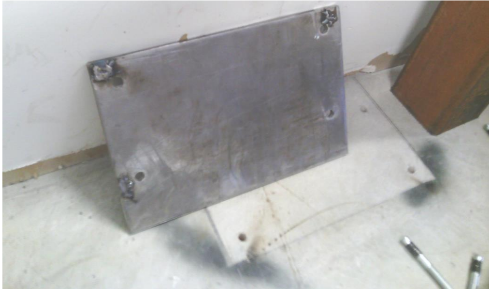
Kuva 30. Aluslevyjien alle hitsatut peltilevyt.
