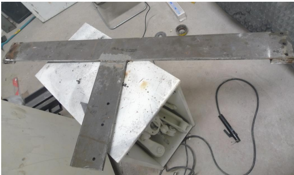
Kuva 31. Etummaisen tukipilarin seinäkiinnikkeen valmistus.
