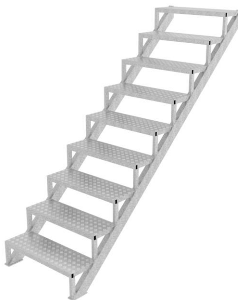
Kuva 10. Esimerkki porrarakenteen ratkaisusta ilman kaidetta.
