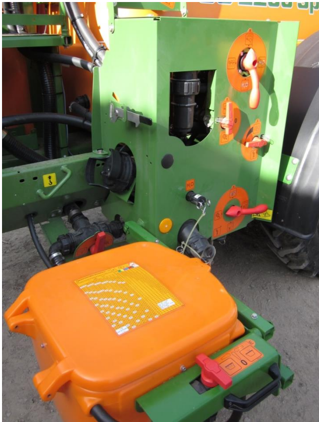
Kuva 4. Amazone UG 2200 –kasvinsuojeluruiskun kemikaalintäyttöastia.
