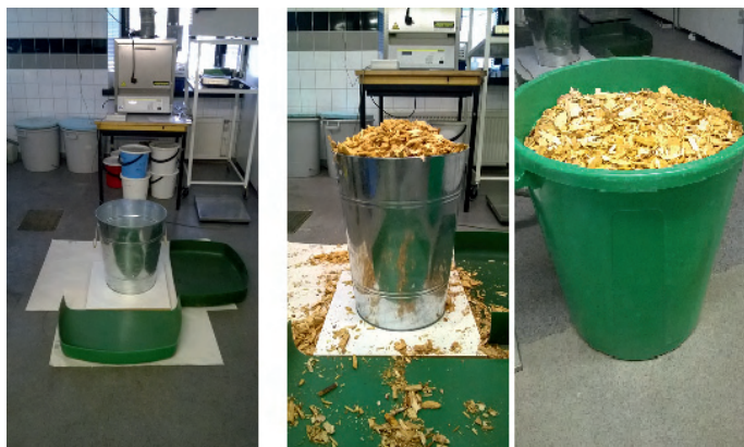
KUVA 2. Irtotiheyden määrittäminen raaka-ainehakkeelle (kuvat Jemina Suikki)
