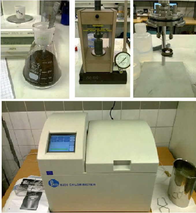
KUVA 1. Lämpöarvomääritys pommikalorimetrillä (kuvat Jemina Suikki)
