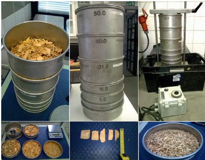
KUVA 4. Palakokomääritys raaka-ainehakkeille seulasarjoihin tärätysmenetelmällä (kuvat Jemina Suikki)
