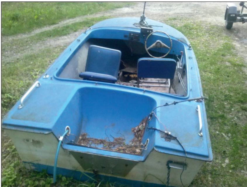
KUVA 3. Käytöstä poistuva vene on monimateriaalituote. Vene voi sisältää lujitemuovin lisäksi metalleja (teräs, RST, messinki, kupari, lyijy jne.), myrkkymaaleja ja muoveja (kuva Dick Blom)
