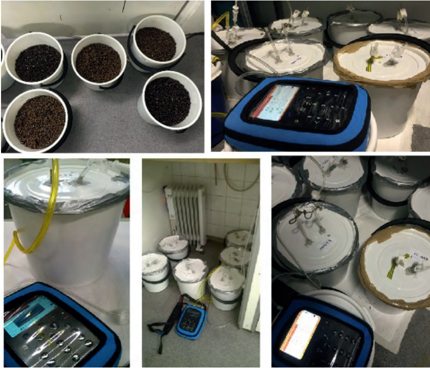
KUVA 1. Pellettien siilosäilytystä jäljittelevä laboratoriomittakaavainen koejärjestely (kuvat Jemina Suikki)
