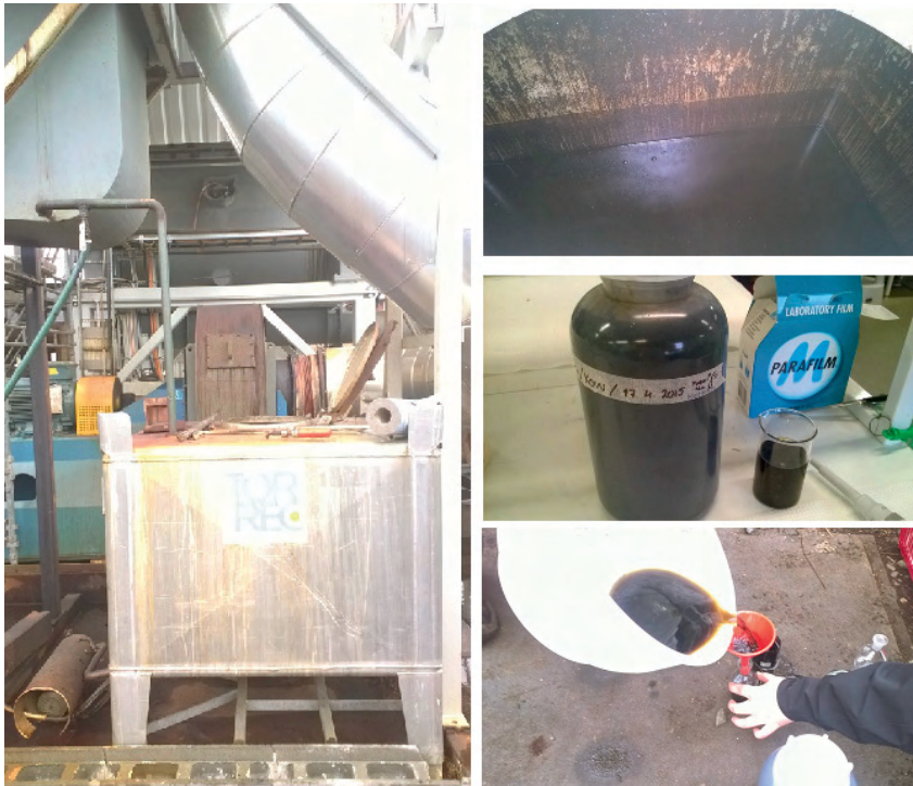
KUVA 1. Prosessissa vapautunut lauhdevesi ja sen näytteenotto (kuvat Jemina Suikki)
