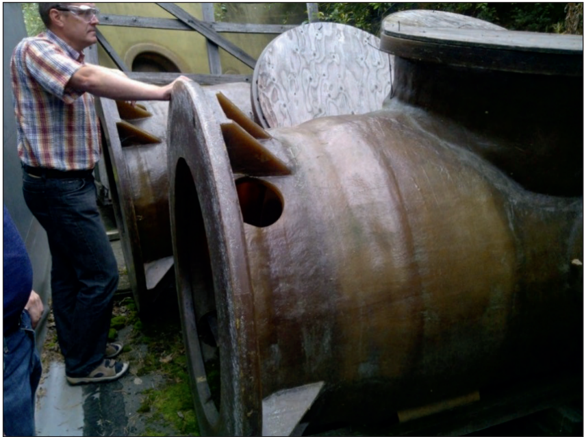
KUVA 4. Prosessiteollisuudessa käytettävä suurikokoinen ja seinämän läpimitaltaan paksu putkiyhde. Nämä saattavat vielä sisältää teräsosia, jotka tulee saada erilleen murskauksen yhteydessä (kuva Dick Blom)
