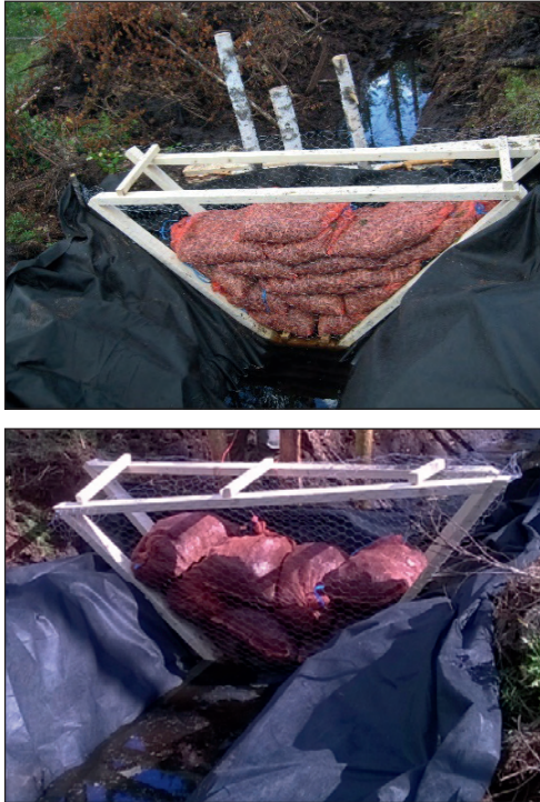
KUVA 2. Hake- ja biohiilisuodattimet ensimmäisessä pilot-kohteessa (kuvat Hanne Soininen)
