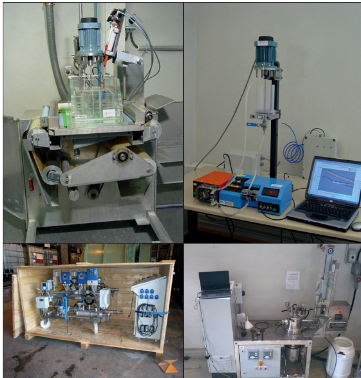
KUVA 5. Kuitulaboratorion sekoituksen kemiallisten ilmiöiden tutkimiseen soveltuvia laitteita. Ylhäältä vasemmalta lukien Moving Belt Former (MBF), Retention Process Analyser (RPA), Retention Process Loop (RP-luoppi) ja laboratorioreaktori (kuvat Mamk Oy)
