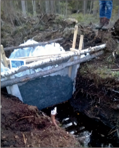
KUVA 3. Toisen pilot-kohteen hiilisuodatin (kuva Tuija Ranta-Korhonen)
