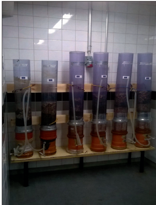
KUVA 1. Ensimmäisen koesarjan suodatinkolonnit (kuva Tuija Ranta-Korhonen)
