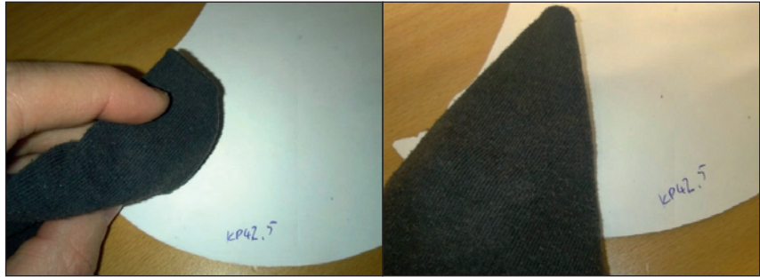
KUVA 5. Painoalustaa (KP42) hangattiin mustalla kankaalla. Kankaaseen ei tarttunut valkoista pölyä (kuva Tuomas Pesonen)
