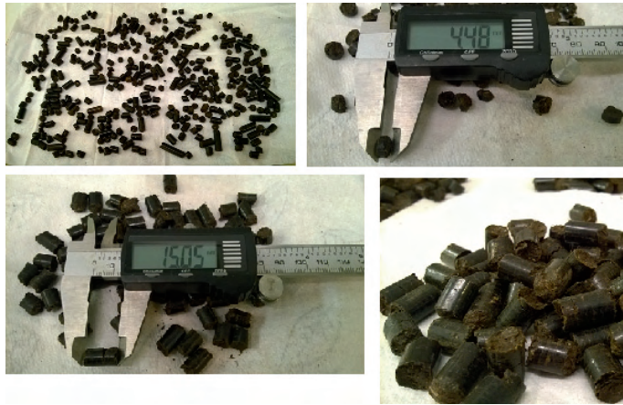
KUVA 5. Pellettien pituuden ja halkaisijan määrittäminen (kuvat Jemina Suikki)
