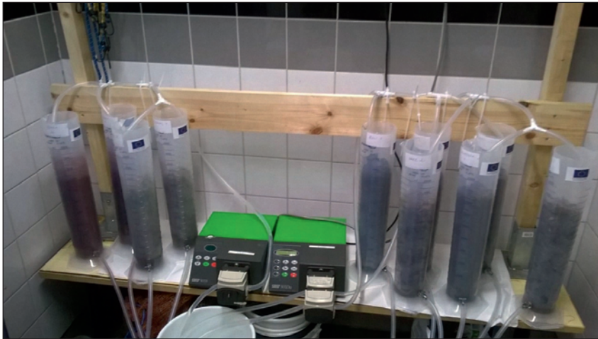
KUVA 2. Toisen koesarjan suodatinkolonnit (kuva Tuija Ranta-Korhonen)
