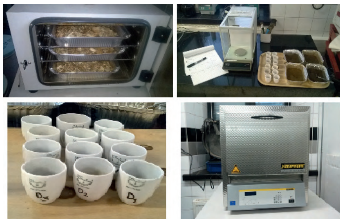
KUVA 3. Kosteus- ja tuhkapitoisuusmäärittäminen biopolttoaineista (kuvat Jemina Suikki)
