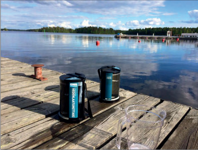
KUVA 1. iQwtr-laite veden laadun mittaamiseen (kuva Suomen ympäristökeskus)
