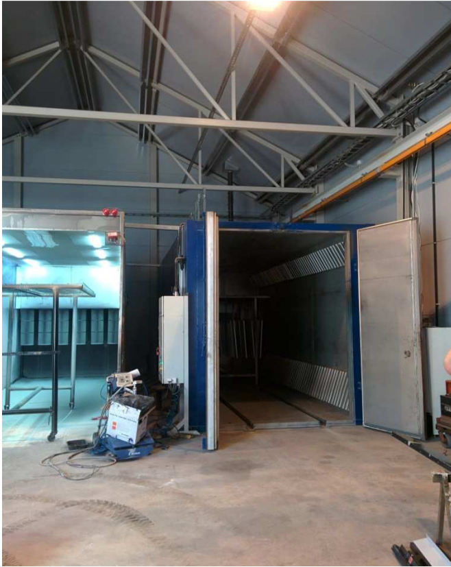
Figur 9. Pulverlackeringslinjens torkningsugn. Längsmed den gula balken till höger på bilden går traversen. Fotograf Max Nybondas. Västanfjärd 2015.
