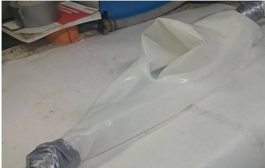
Kuva 14 Silikonista valmistettu asennuspussi eli bladderi. Pussin haara-osa on käännetty runko-osan sisään (Valokuva Newliner Sukitus työryhmä 6 asennus kuorma autosta, 10.2.2015 kuvaaja: Niklas Sinisalo)
