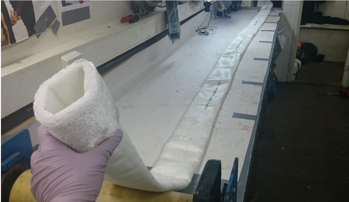
Kuva 5 Kokoaan muuttava 100/150mm sukka työpöydällä ennen epoksointia ja asennusta. Kuvan alareunassa näkyy mankeli. (Valokuva Newliner Sukitus työryhmä 3, 15.01 2015 kuvaaja: Niklas Sinisalo)
