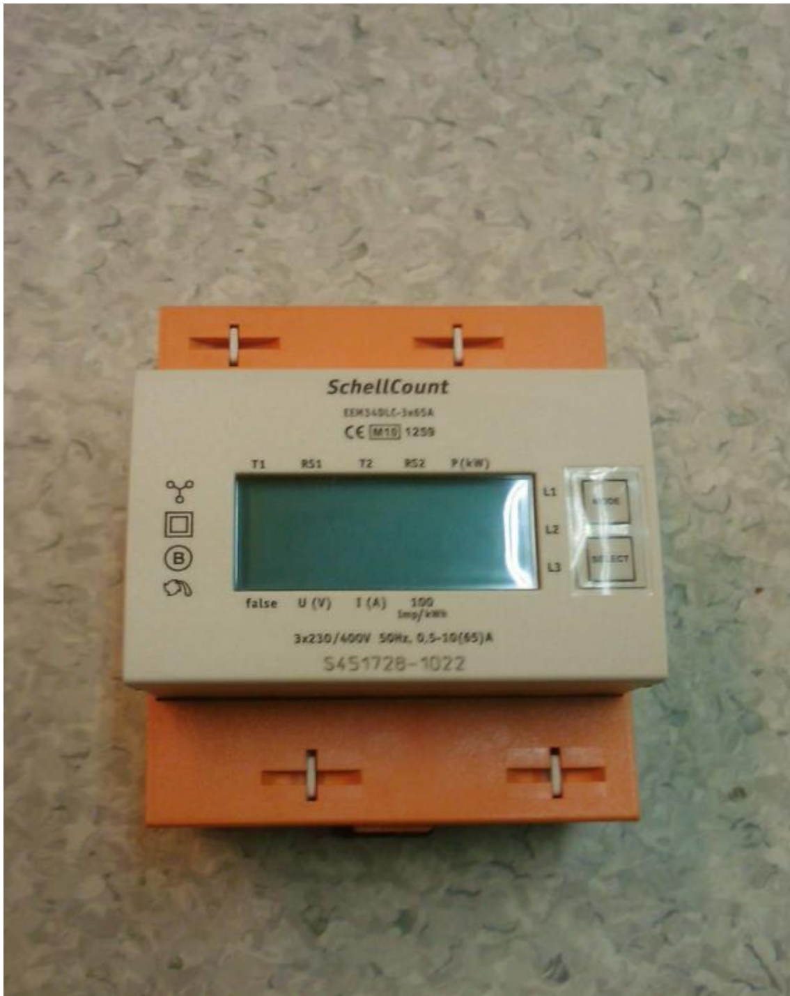
KUVA 3. SchellCount EEM34 DLC-3x65A -kolmivaihe-energiamittari
