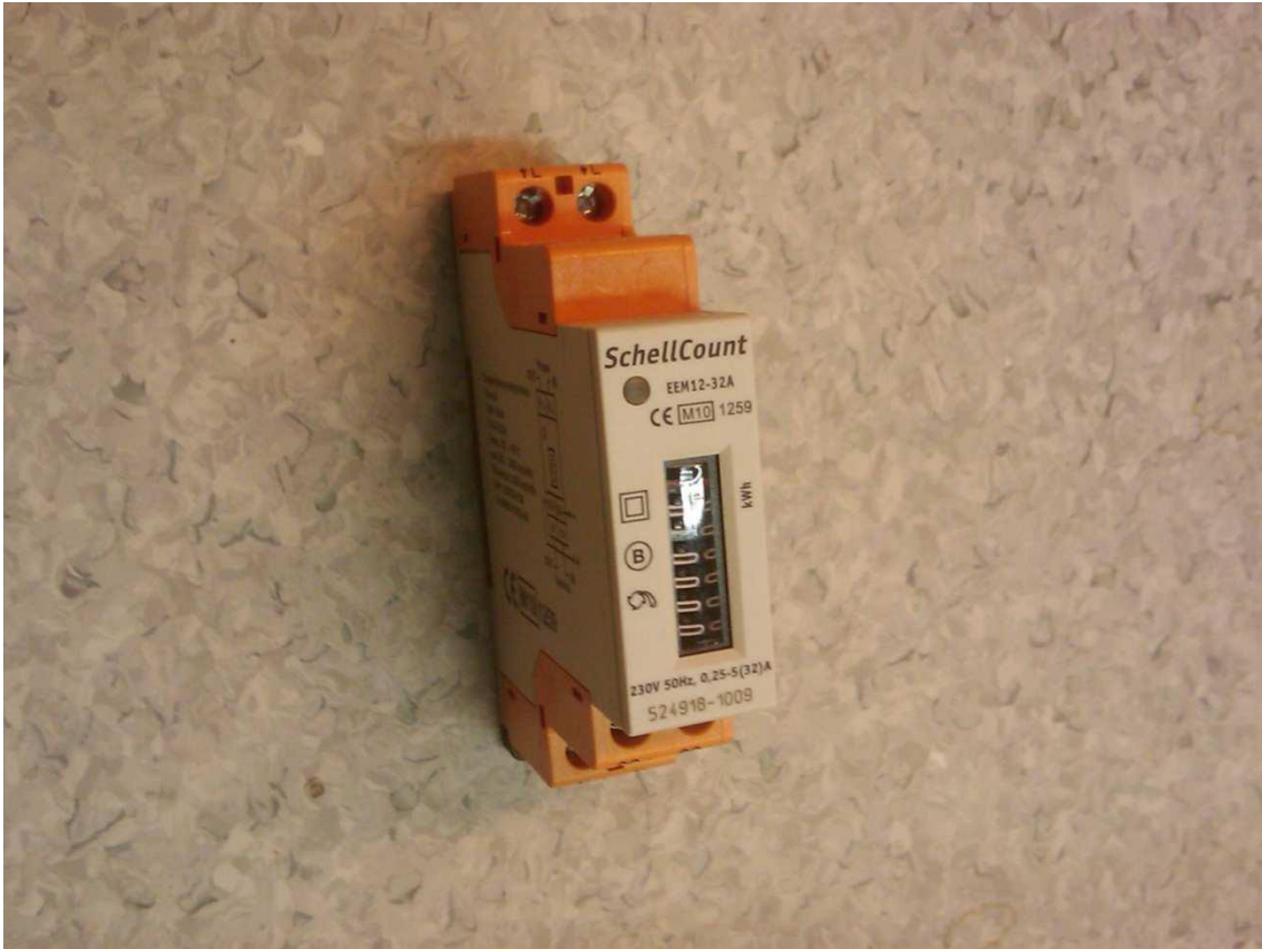
KUVA 2. SchellCount EEM12-32A -energiankulutusmittari
