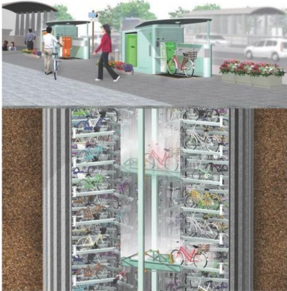
Kuva 28. Giken LTD.:n robottipysäköintilaitos polkupyörille (Moro 2013).
