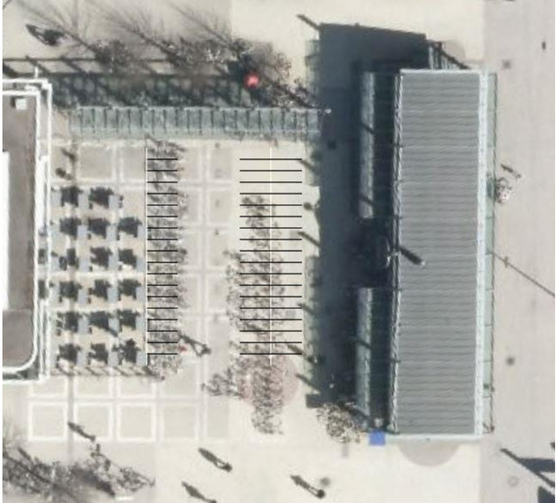
Kuva 16. Pysäköintialueen suunnitelma ylhäältä kuvattuna. Mustat viivat kuvastavat runkolukituskaaria ja oikean puoleisessa pysäköinnissä kaaria on kaksi lähes kiinni toisissaan. (Karttakerttu.) Kuva ei ole mittakaavassa.
