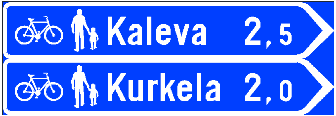
Kuva 24. Liikennemerkki numero 645, kevyen liikenteen viitta. Viitta on kuvitteellinen ja se on piirretty Novapoint-ohjelmistolla.
