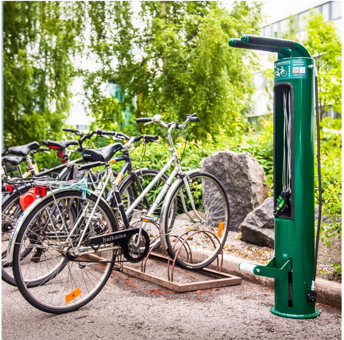
Kuva 20. Bfix Oy:n valmistama ja markkinoima pyörähuoltopiste. Huollettava pyörä nostetaan satulasta roikkumaan kahden mustan tangon väliin. Huoltopisteestä löytyy jalkakäyttöinen korkeapainepumppu universaalisuuttimella renkaiden täyttämiseen sekä työkaluvalikoima. Työkaluvalikoimaan kuuluu kuusiokoloavainsarja, torx-avain T25, risti- ja talttapää ruuvimeisselit, jakoavain, renkasrauta, pinna-avain ja kartiokiintoavain. (Bfix Oy.)
