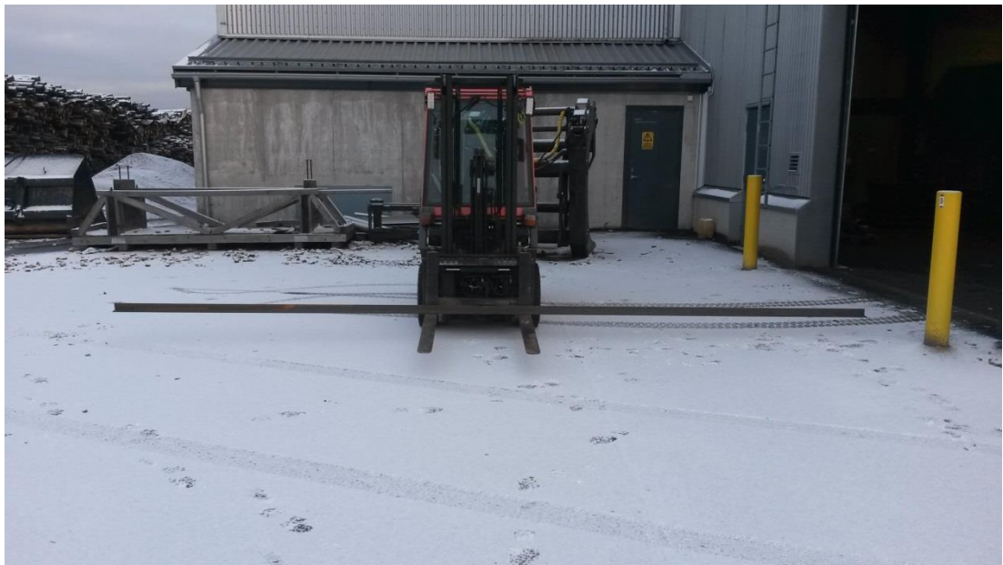
Kuva 28. Trukki materiaalivaraston edessä. Teräsprofiili on vedetty trukkiپیökkien päälle verstaalle kuljetusta varten. Profiili on nostettu ulos varastosta yhden henkilön voimin. Varaston ovesta ei mahdu ajamaan pitkän profiilin kanssa.
