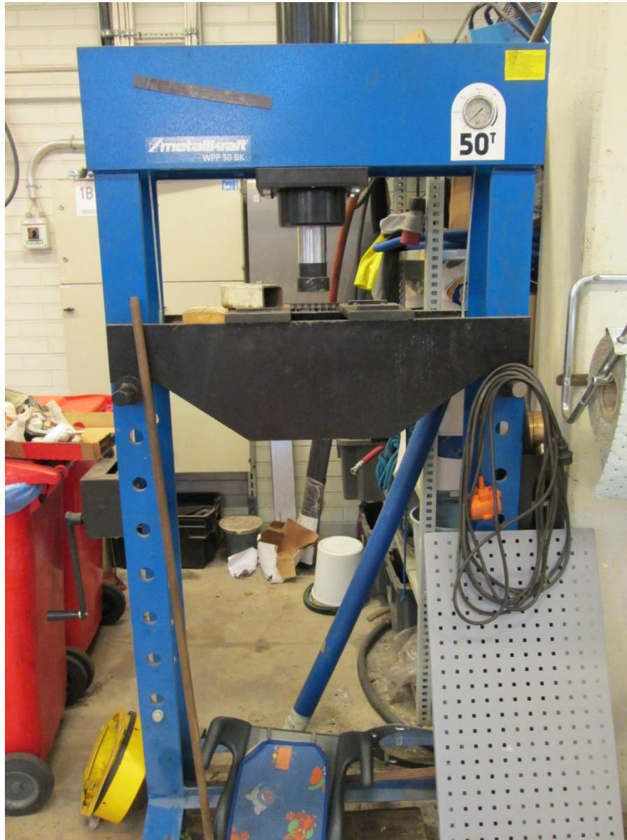
Kuva 5. Hydrauliprässissä on saksankieliset turvaohjeet pienessä tarrassa oikealla ylhäällä.
