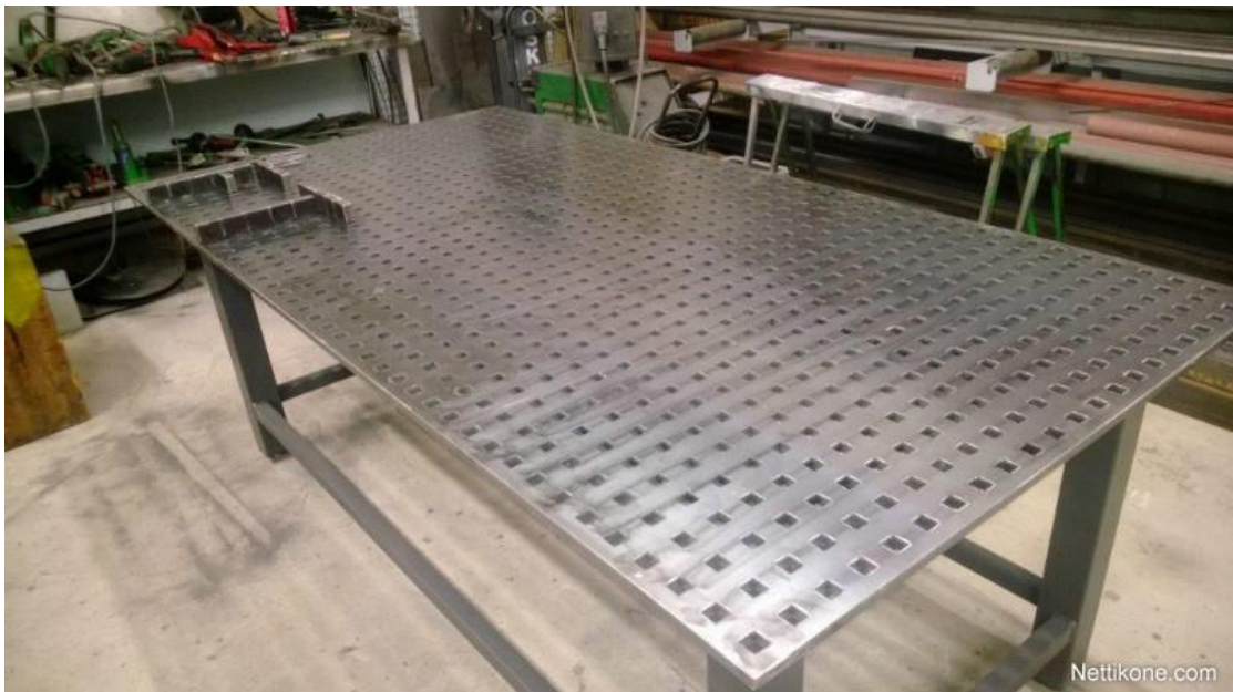
Kuva 24. Teräsrakenteinen hitsauspöytä mihin saa kiinnitettyä erilaisia asennuspaloja hitsattavien kappaleiden asettelua helpottamaan. Reikien avulla pöytään voidaan kiinnittää myös ruuvi- penkki tai mikä tahansa muu apuväline. (18.)
