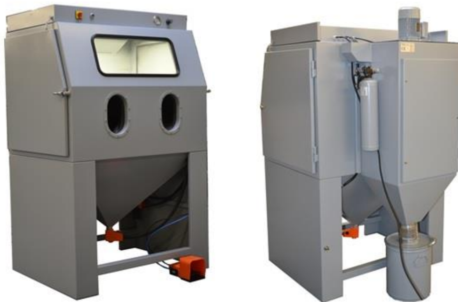
Kuva 22. Raepuhalluskaappi. Kaapissa on oma imulaitteisto lian ja pölyn talteen ottamiseksi huoneilmasta. Kaappi kierrättää käytetyt puhallusrakeet uudelleenkäytettäviksi. (16.)
