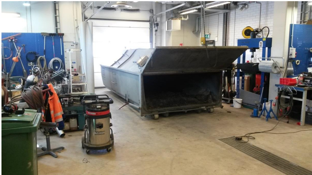
Kuva 8. Arinatuhkalavan luukku avattu ketjunostimen avulla.
