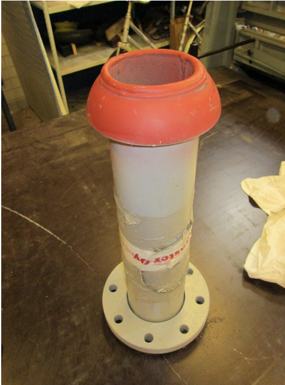
Kuva 12. Hiekkasiilon vahvistettu täyttöyhde asennusvalmiina.
