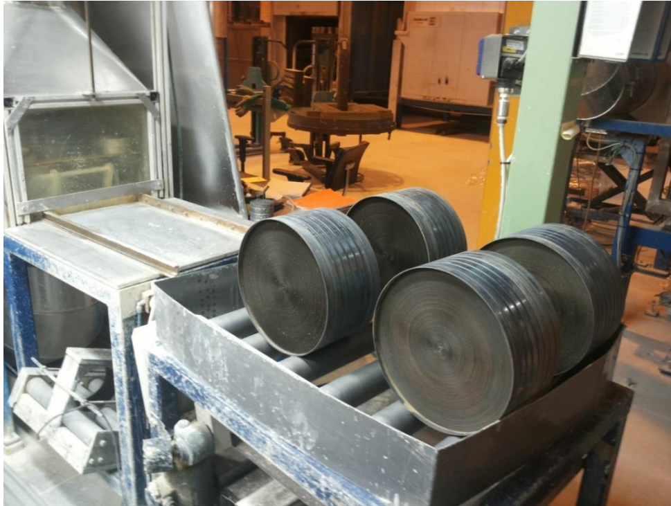
KUVIO 38. Kuivaus kerää kuorma-autokatalysaattoreita puskuriin.
