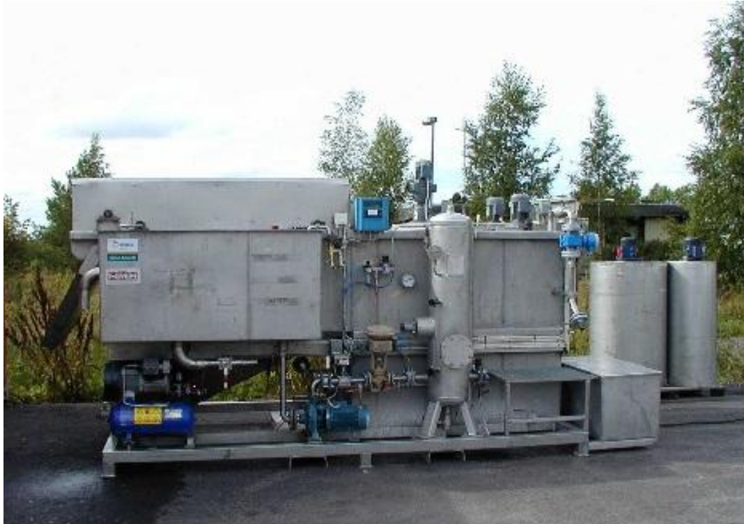
Kuva 14. DAF pilot -laitteisto. Testattava vesi virtaa sisään laitteiston oikeasta reunasta virtausmittauksen kautta ja ulostulo kuvan vasemmasta reunasta. Keskellä on dispersioveden valmistamiseen käytettävä painetankki.
