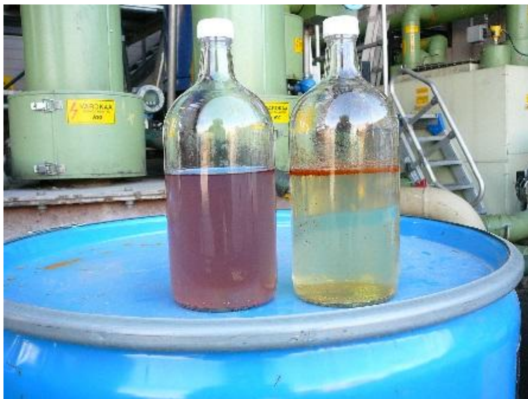
Kuva 15. Kenttäolosuhteissa tehty pullokoe osoitti, kuinka kemikaalien lisääminen tehosti ja nopeutti rasvan erottumista veden pinnalle. Oikeanpuoleiseen pulloon on lisätty sekä lipeää että polyelektrolyyttiä.
