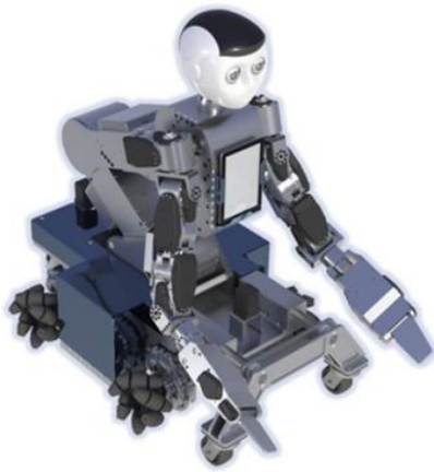
Kuva 30: roboticsbusinessreview.com/article/hstar_technologies_rona_robotic_nursing_assistant_system/ Kuva 30. Hstar Technologiesin palkittu Rona –nostorobotti, joka on suunniteltu hoitajan käytettäväksi yli 200kg painavien potilaiden nostamiseen.
