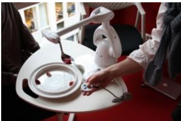
Kuva 21. Bestic syöttörobottia käytetään kauko-ohjaimella.
