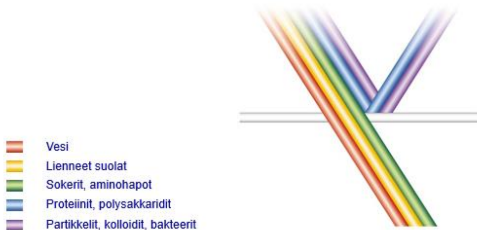
Kuva 5 Ultrasuodatuskalvo pidättää partikkelit, kolloidit, bakteerit sekä proteiinit (retentaatti) ja päästää lävitseen sokerit, suolat ja veden (permeaatti) (Jensen, D. esitysmateriaali PowerPoint-diat. Bio- ja elintarviketekniikan koulutusohjelma. Hämeen ammattikorkeakoulu.)
