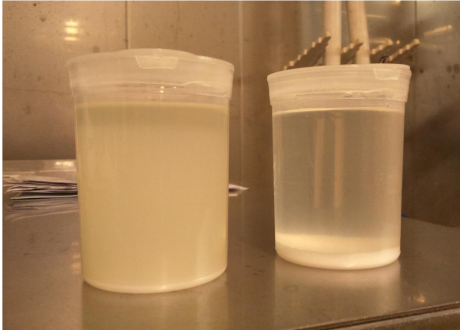
Kuva 13 Juustohera ja pesuvesi -näytteet, joiden on annettu seistä koskemattomina yön yli. Juustopöly näkyy laskeutuneen näytepurkkien pohjalle. (Kuva: Rinna Heinonen, 2015)
