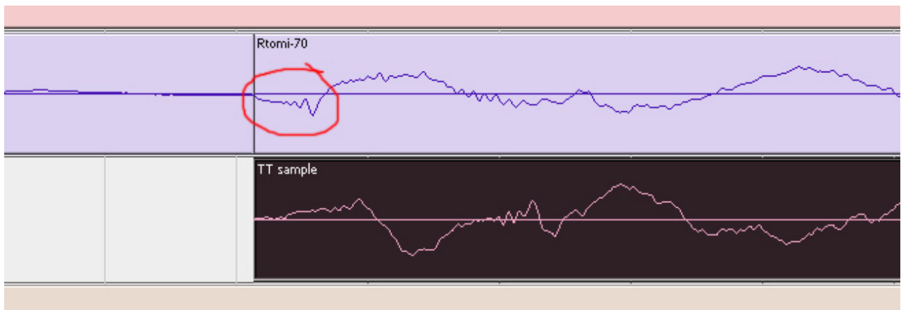
Kuva 4.7 Kapulan osuminen rumpukalvoon näkyy lyhyenä notkahduksena verhokäyrällä.
