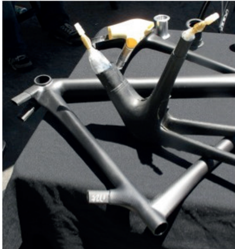
Kuva 4. Palasista kasattava hiilikuiturunko, jonka sisällä "rakko" (Dirt Rag 2011).
