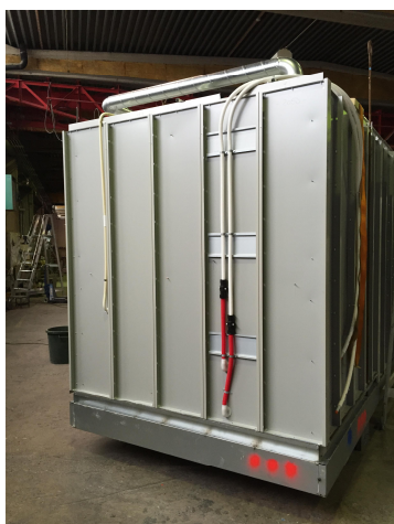
Kuva 9. Kylpyhuone-elementin kyljissä kulkevaa tekniikkaa.(6)
