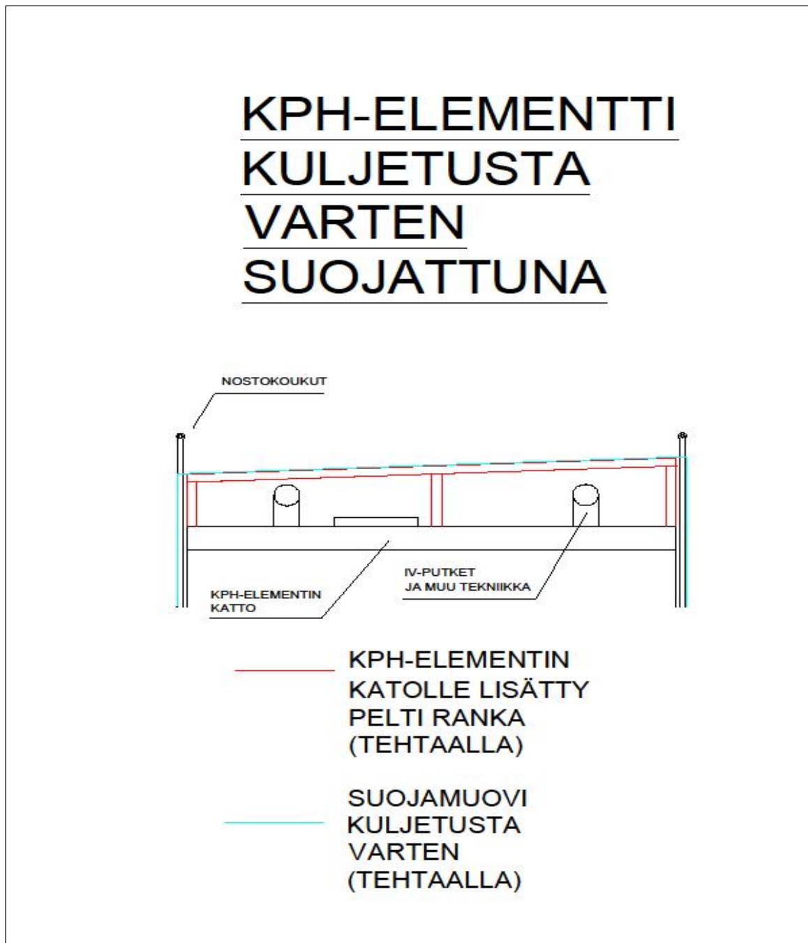
Kuva 13. KPH-elementti kuljetusta varten suojattuna.
