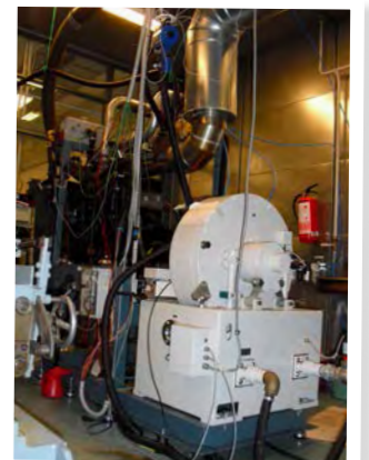
Bränslen testades i en AGCO Sisu Power 44CWA Non-road dieselmotor i Technobotnias motorlaboratorium.
