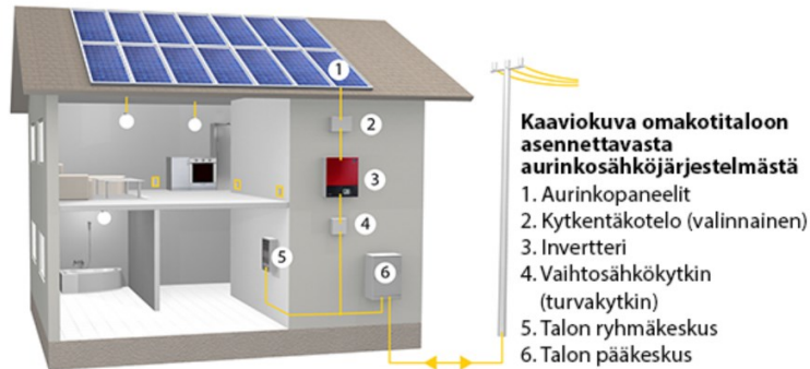
Kuva 1. Omakotitalon aurinkosähköjärjestelmä (Areva Solar Oy 2015).
