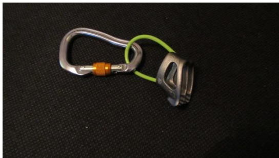
KUVA 3. Varmistuslaite ATC ja sulkurengas (Niko Ohtamaa 2015)
