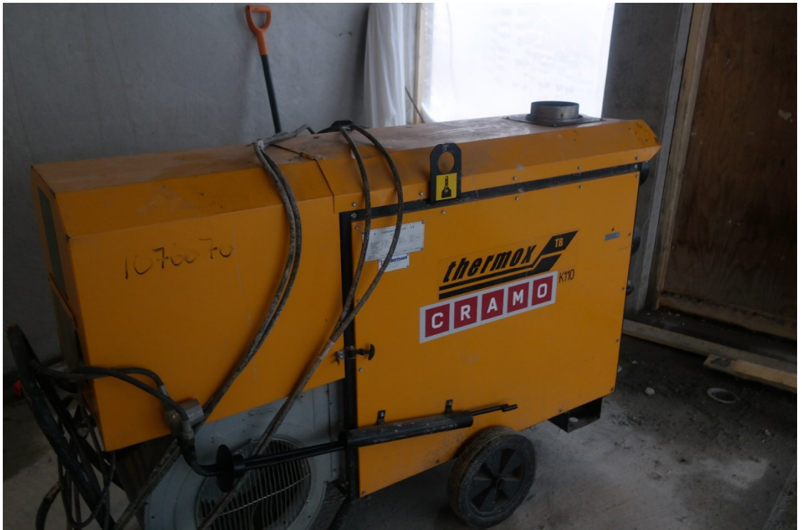
KUVA 6. Öljylämmitin, jota käytetään ontelolaattojen lämmittämiseen alhaaltapäin (Hartikainen 2016-01-26)
