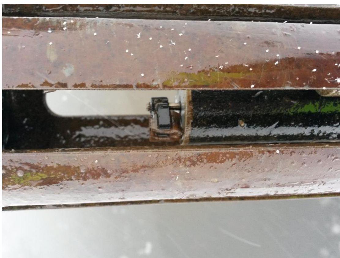
KUVA 32. Vesistössä olleen sondin sameusanturi on likaantunut voimakkaasti (Viljanen 2015)
