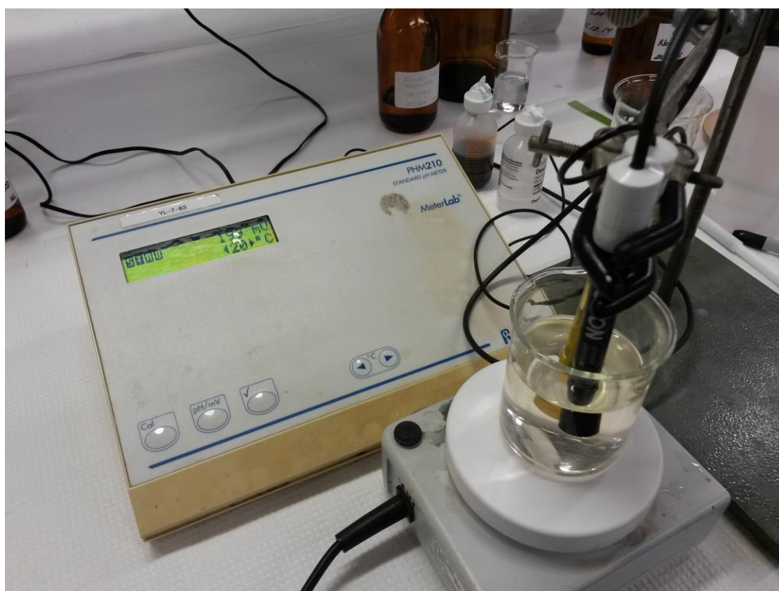
KUVA 15. Kloridin määrittäminen pH-mittarilla (Viljanen 2015)
