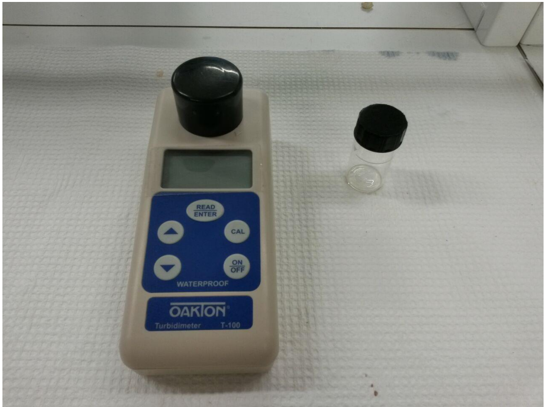
KUVA 11. Sameusmittari Oaklon Turbidimeter T-100 (Viljanen 2015)
