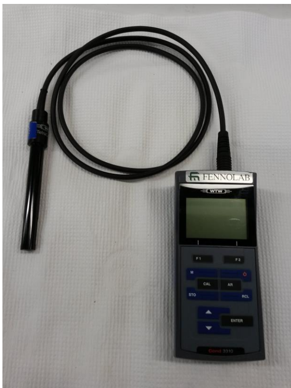
KUVA 13. Sähkönjohtavuuden mittauslaite Fennolab WTW Cond 3310 (Viljanen 2015)
