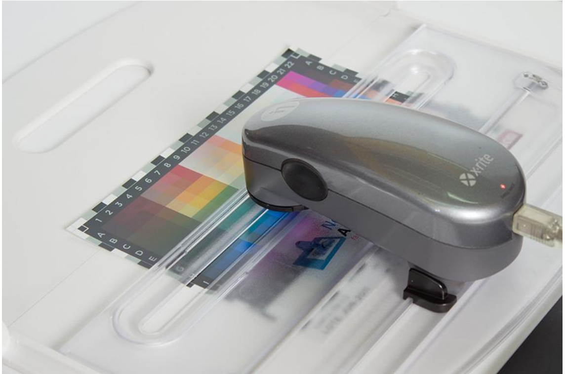
Kuva 5. X-Rite Eye One -spektrofotometri ja IT8.7/2-testikartta.
