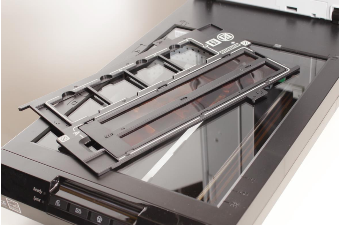
Kuva 6. Epson V550 -tasoskannerin kinofilmi- ja diapidike.
