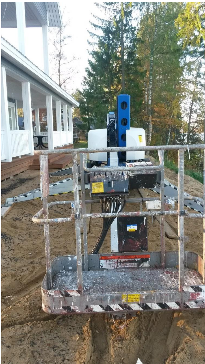
Kuva 11. Henkilönostin tukijalat levitettynä.
