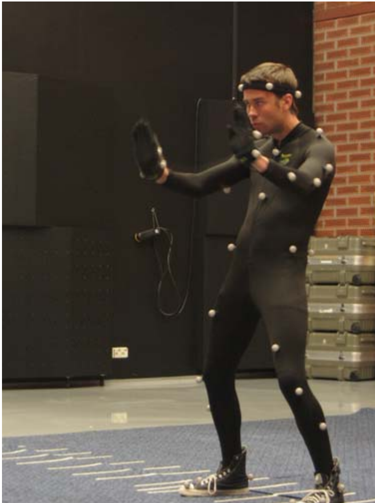
Kuva 4. Liikkeenkaappausnäyttelijä optisessa liikkeenkaappauspuvussa
