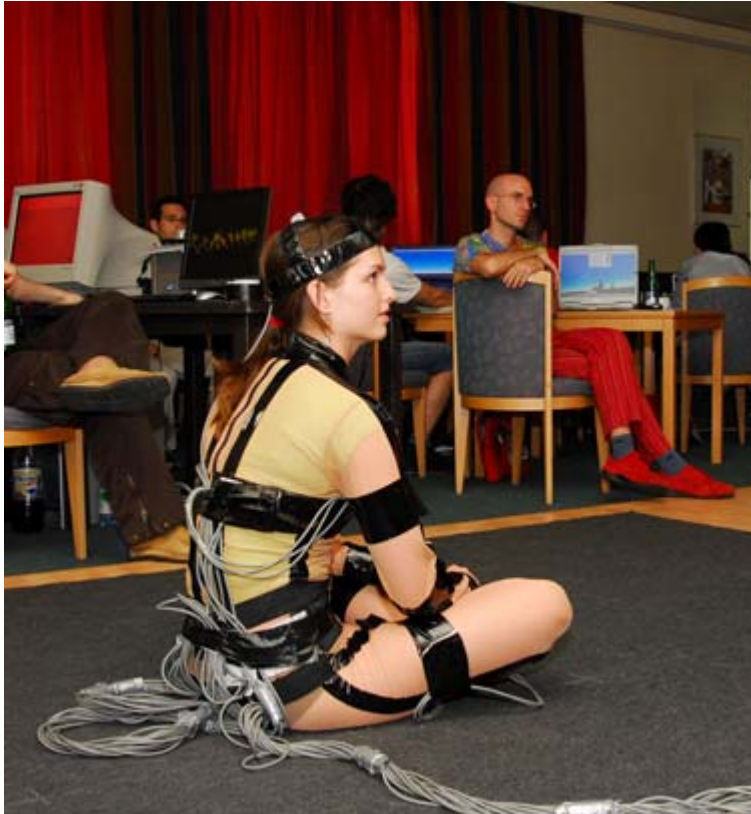
Kuva 2. Liikkeenkaappausnäyttelijä magneettisessa liikkeenkaappauspuvussa
