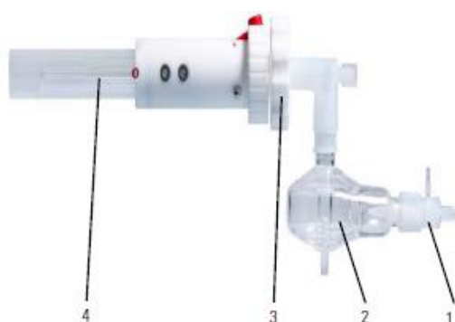
KUVA 1. 1 = sumutin, 2 = sumukammio, 3 = injektori, 4 = soihtu (Thermo Scientific 2012a, 19–20, muokattu)
