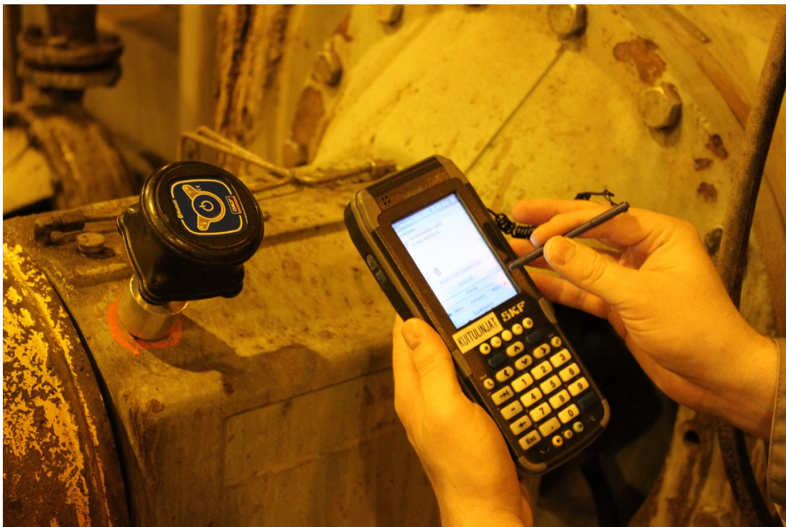
Kuva 5. Värähtelymittaus käynnissä (Kuva: Jussi Nuutinen).
