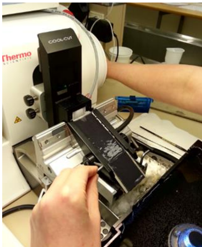
KUVA 3. Blokkien leikkaaminen vesiliukumikrotomilla (Heikkinen ja Rutanen 2015-11-23.)
