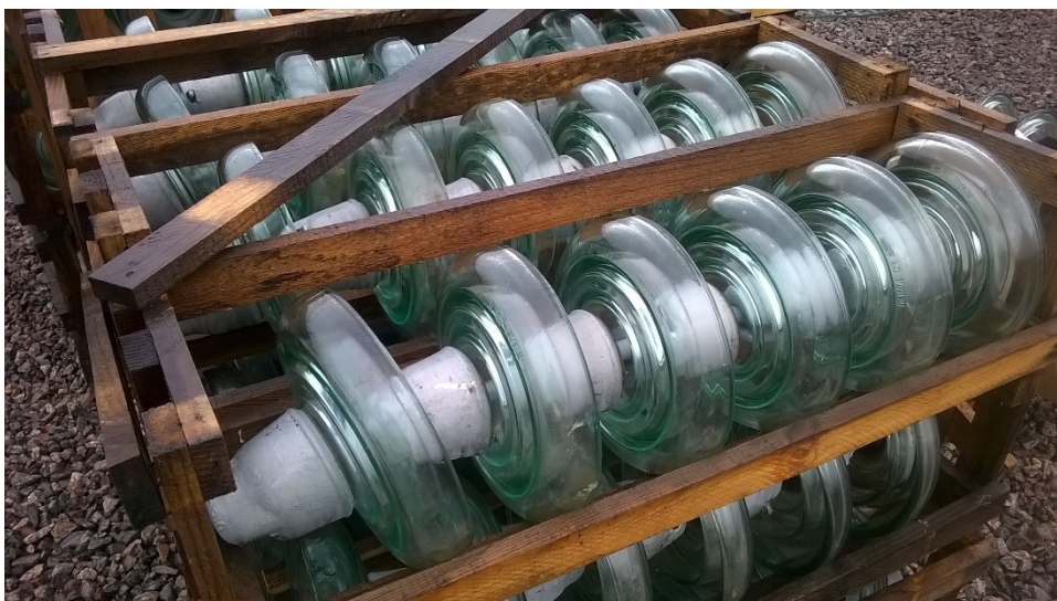
Kuva 2. Petäjäveden uusille 400 kV linjoille tulevat lasieristinketjut.
