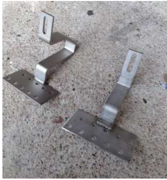
Kuva 30: IBC Solarin uusi ja vanha kiinnike, uusi korvasi vanhan vuonna 2014. Vasemmalla oleva uusi kiinnike ei taivu yhtä herkästi kattotiiltä vasten. Alhaalla oleva reikälevy on kattoon kiinnitystä varten ja ylhäällä olevaan soikeaan reikään kiinnitetään asennuskiskot. (aurinkovirta 2015)
