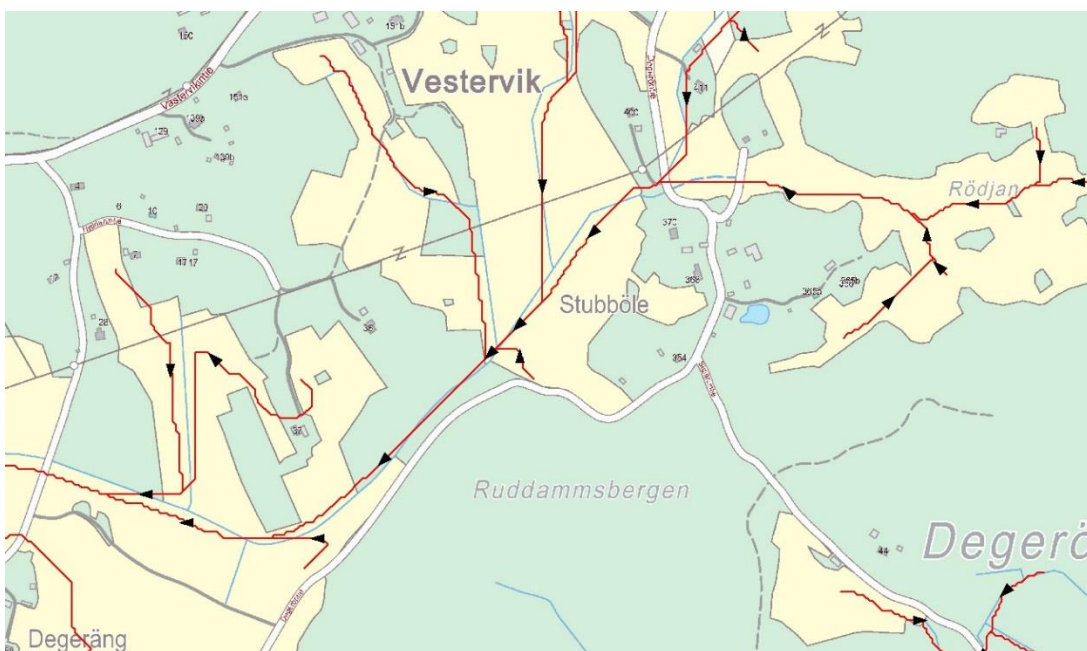
Bild 14 Raster med 5 meters cellstorlek med bränning. Den mest trovärdiga av modellerna som testats. Flödet rinner genom Degerövägen, från nordost mot sydväst; precis som det gör i verkligheten.
