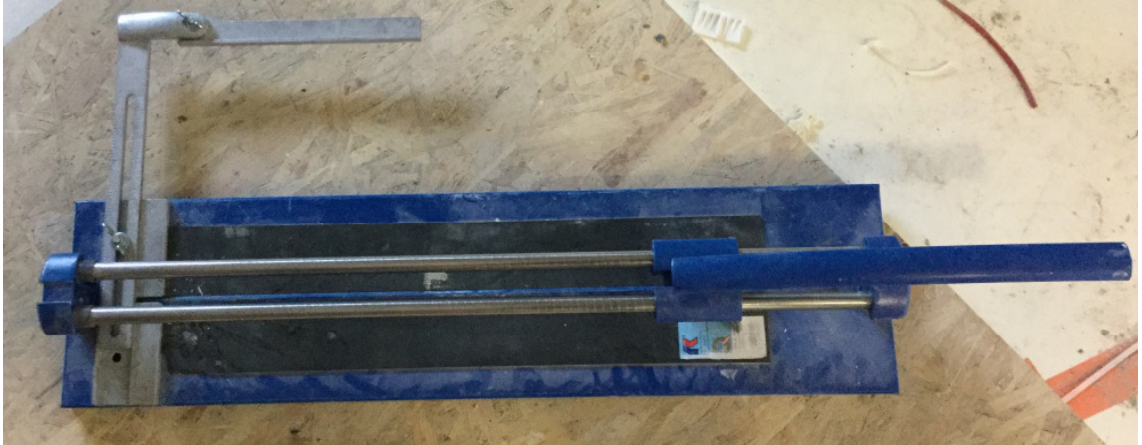
Kuva 27. Laatat leikataan laattaleikkurilla. (Kuva Anne Mutanen)
