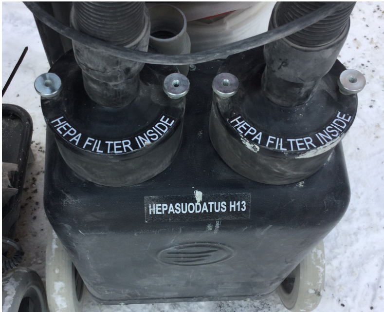
Kuva 7. Imurissa tulee olla HEPA-suodattimet. (Kuva Anne Mutanen)
