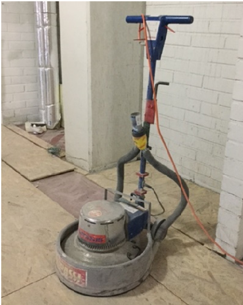
Kuva 20. Lattiahiomakone imuriliitännällä. (Kuva Anne Mutanen)
