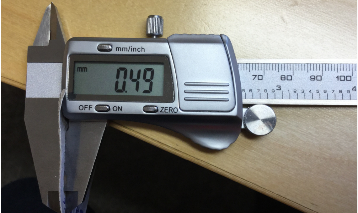
Kuva 28. Vedeneristeiden paksuuden mittaus. (Kuva Anne Mutanen)
