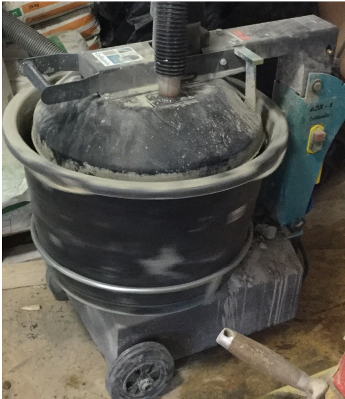
Kuva 23. Kohdepoistolla varustettu kiertosekoitin. (Kuva Anne Mutanen)
