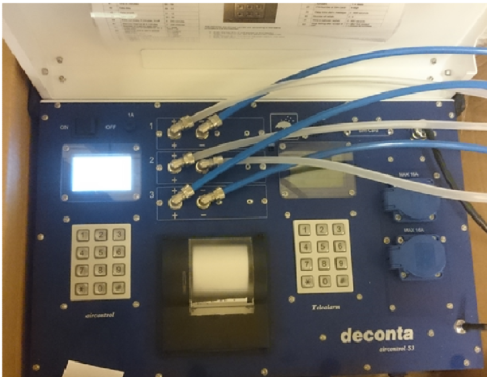
Kuva 5. Paine-eromittarin avulla voidaan seurata alipaineistuksen toimivuutta. (Kuva Anne Mutanen)
