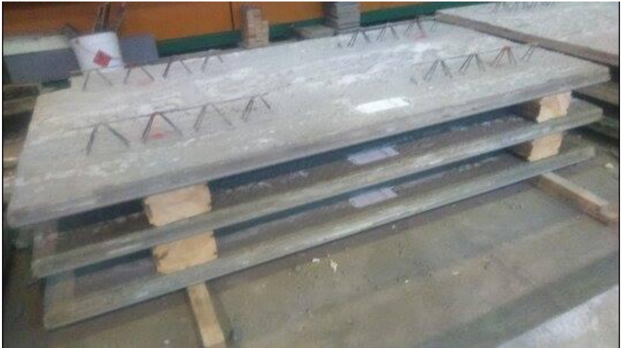
Kuvio 10. Kiirunan kaupungintaloon meneviä valmiita kuorilaattoja.
