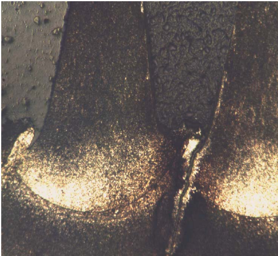
Kuva 7. Murtuma sidospultin kierteen pohjassa.
