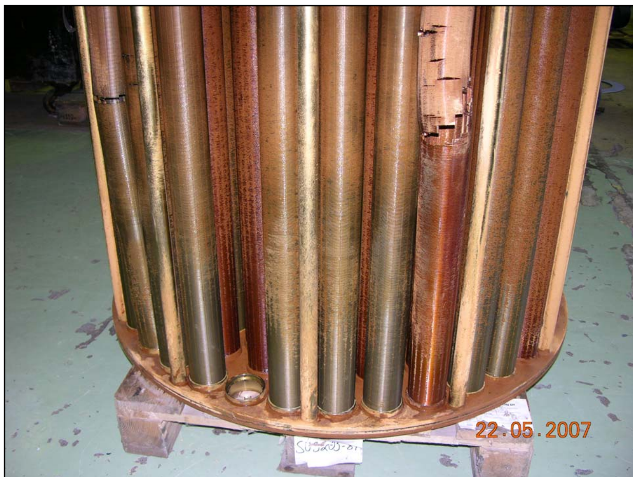
Kuva 3. Vaurioitunut suodatin keväältä 2007.
