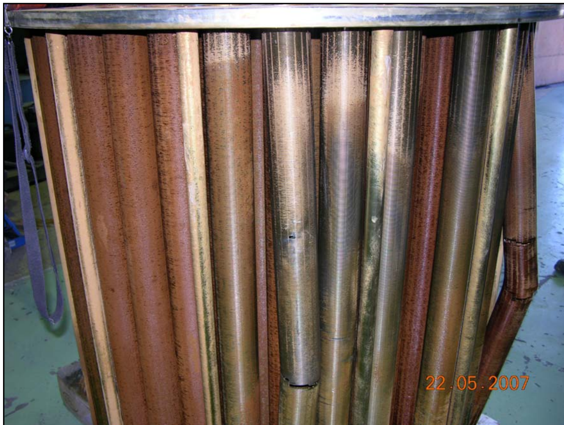
Kuva 2. Vaurioitunut suodatin keväältä 2007.
