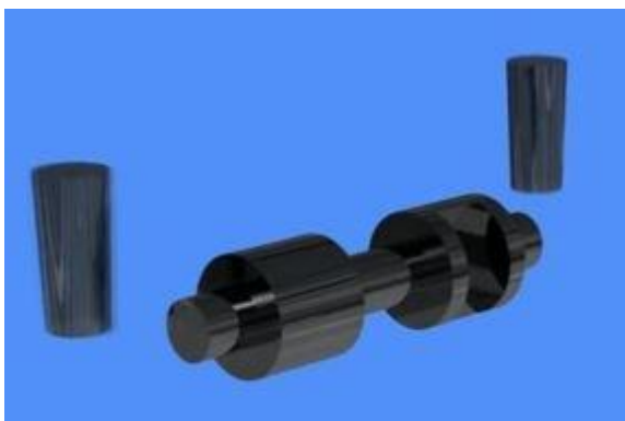
Kuva 18. Valmis viimeistelyhiottu valukappale, josta täyttöaukko- ja kaasu- kanavapurseet on sahattu pois. (China Savvy Sand 2016)
