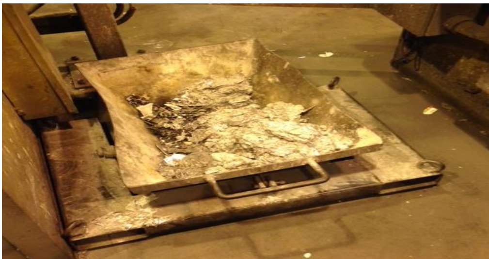
Kuva 25. Kuona on metallurgisen prosessin sivutuote ts. jäte, joka sisältää lopputuotteen kannalta ei-toivottuja aineita. (Mannila 2015)
